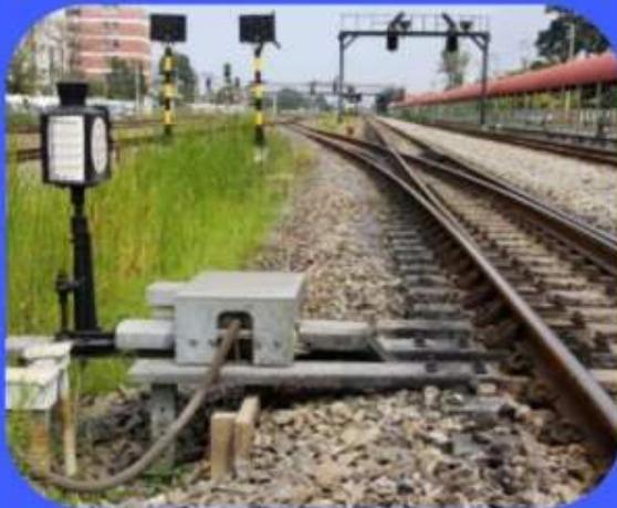
转辙机是道岔的控制设备，通过转辙机可以实现对道岔的转换和锁闭，保障列车运行的顺利进行。
