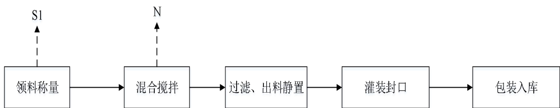
图 2-5 现有项目生产工艺流程及产污环节图
