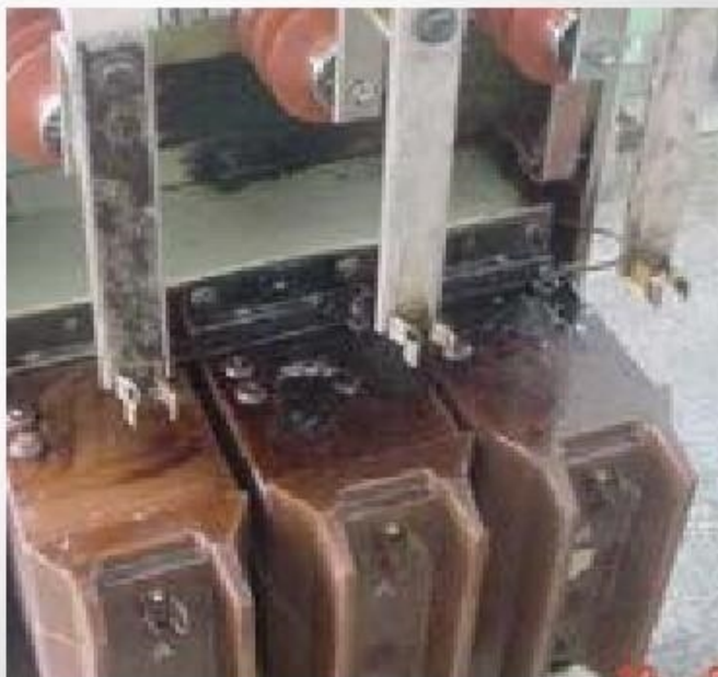
电压互感器二次导线接线端子接触不良引起的绝缘烧损
