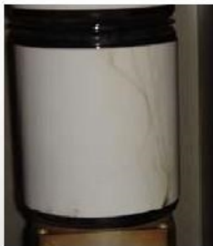
高压开关真空泡表面绝缘电腐蚀
