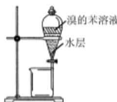
分液，先放出水层，再倒出溴的苯溶液
