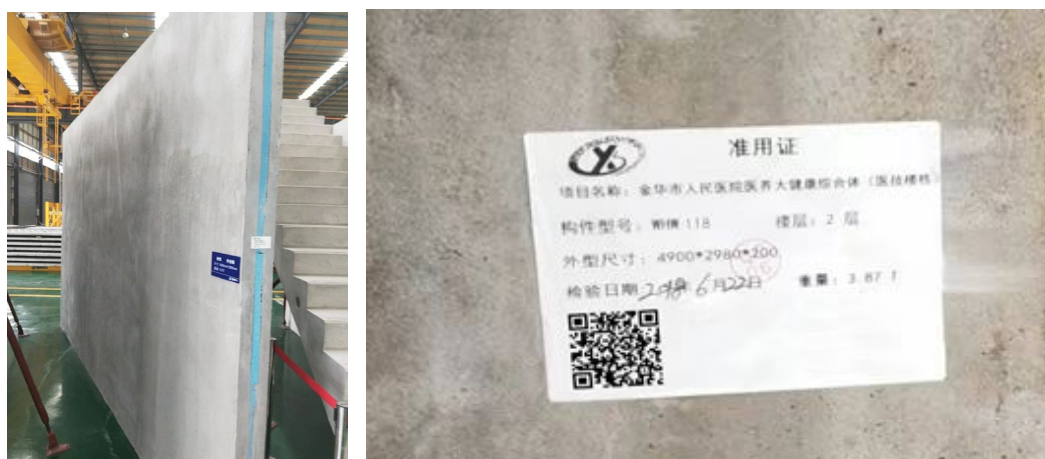
图 5.2.2 混凝土外墙挂板预制及信息化管理
