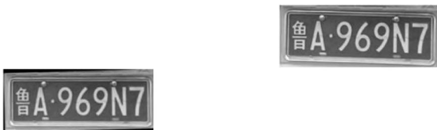
图 4.1 车牌图像水平校正前 图 4.2 车牌图像水平校正后经过两图对比可以看出，经过水平校正后的图片更加规整，更加利于系统对其进行处理。
