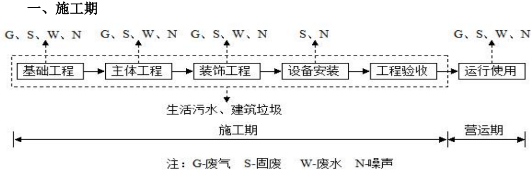
图 2-4 项目施工期工艺流程及产污环节图
