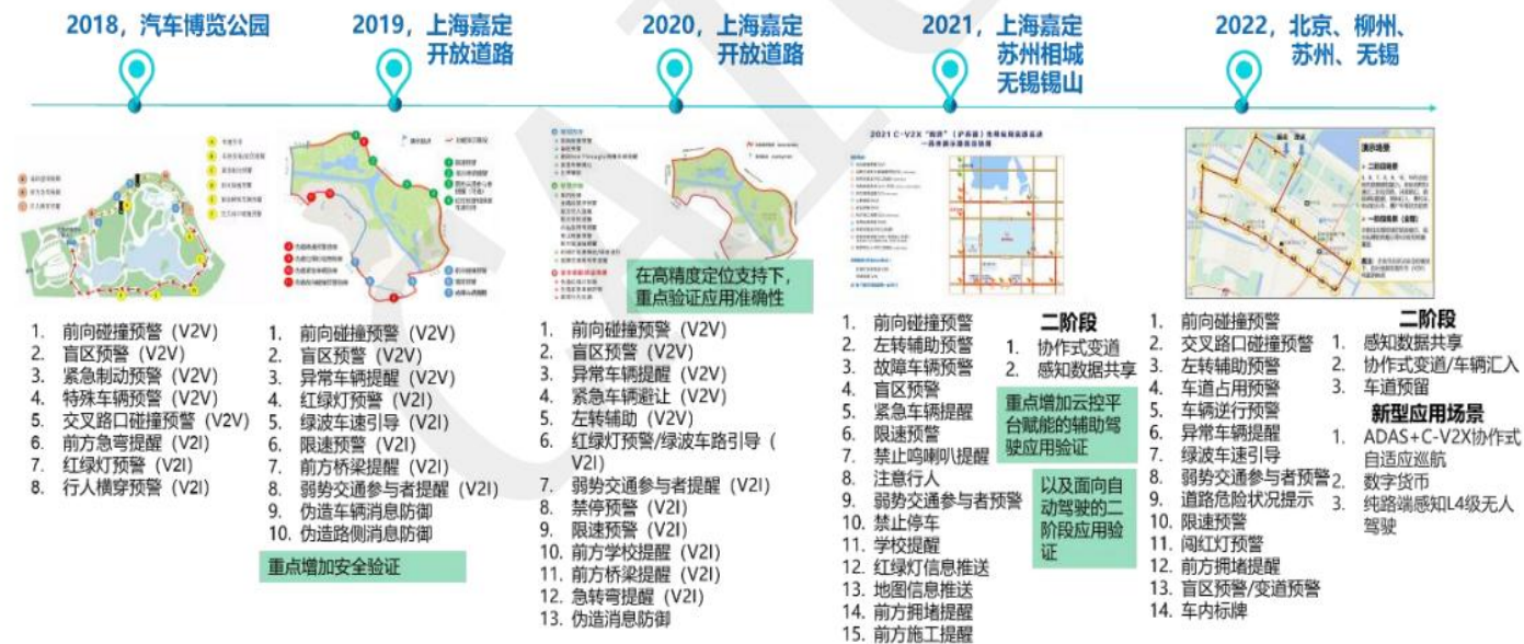
图：车路协同可为车辆提供更多交通信息（以上海先导区试验为例）
