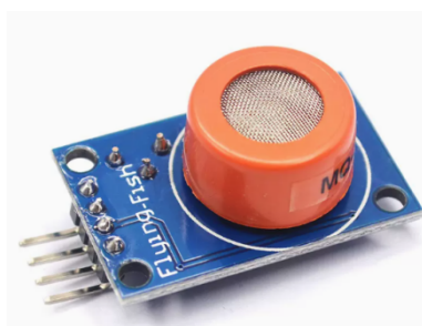
图 2-6 MQ-3 气体检测模块
