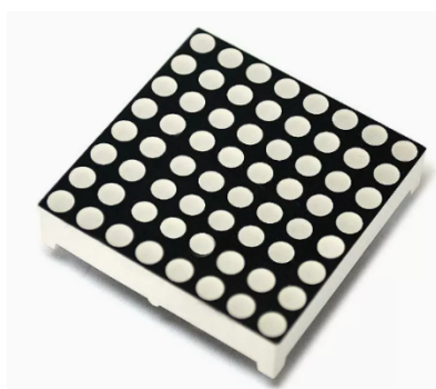
图 2-4 LED 点阵显示器实物图
