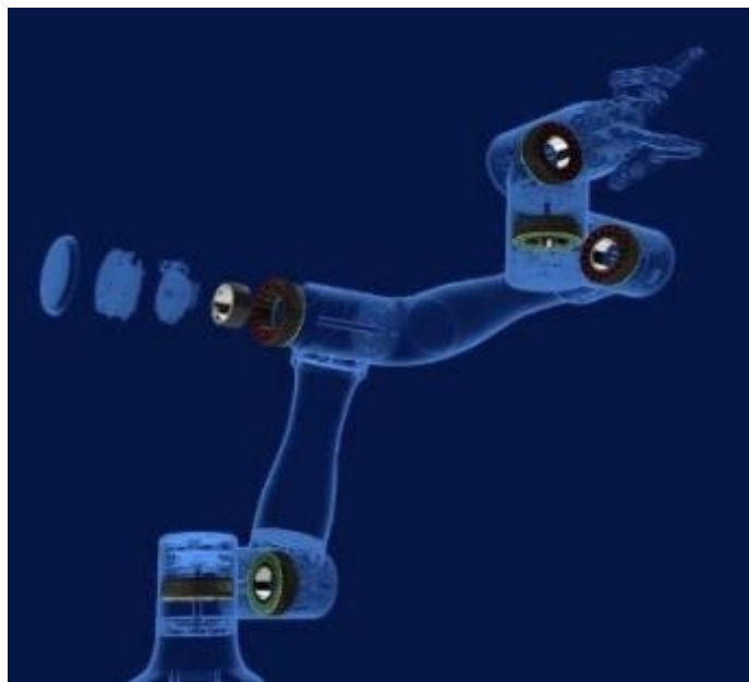
图表：无框电机应用于机器人关节
