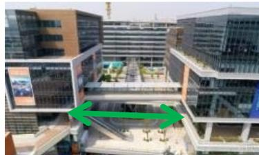
水平动线设计主要是为了串联各个商铺，使各个商铺都能出现在顾客的眼里，同时有明显的通道可以到达。本案的水平动线设计以环形为主，层层退台，团绕中庭一圈为主动线，中间通往局部商铺小径为辐。
