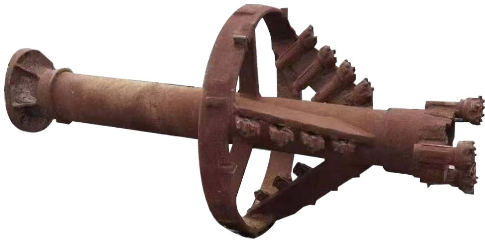
图 2.0.5-3 二次改进后的组合式钻头
