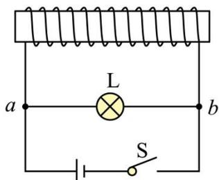
**【答案】** 开关  $S$  断开之前通过灯  $L$  的电流方向由  $a$  到  $b$ ；断开之后的瞬间通过灯  $L$  的电流方向由  $b$  到  $a$ ；
