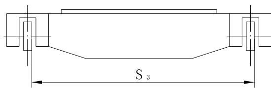
图 A. 0. 3-3 桥式起重机跨度检测
