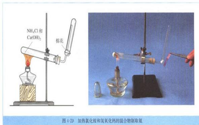
图 4-29 加热氯化铵和氢氧化钙的混合物制取氨
