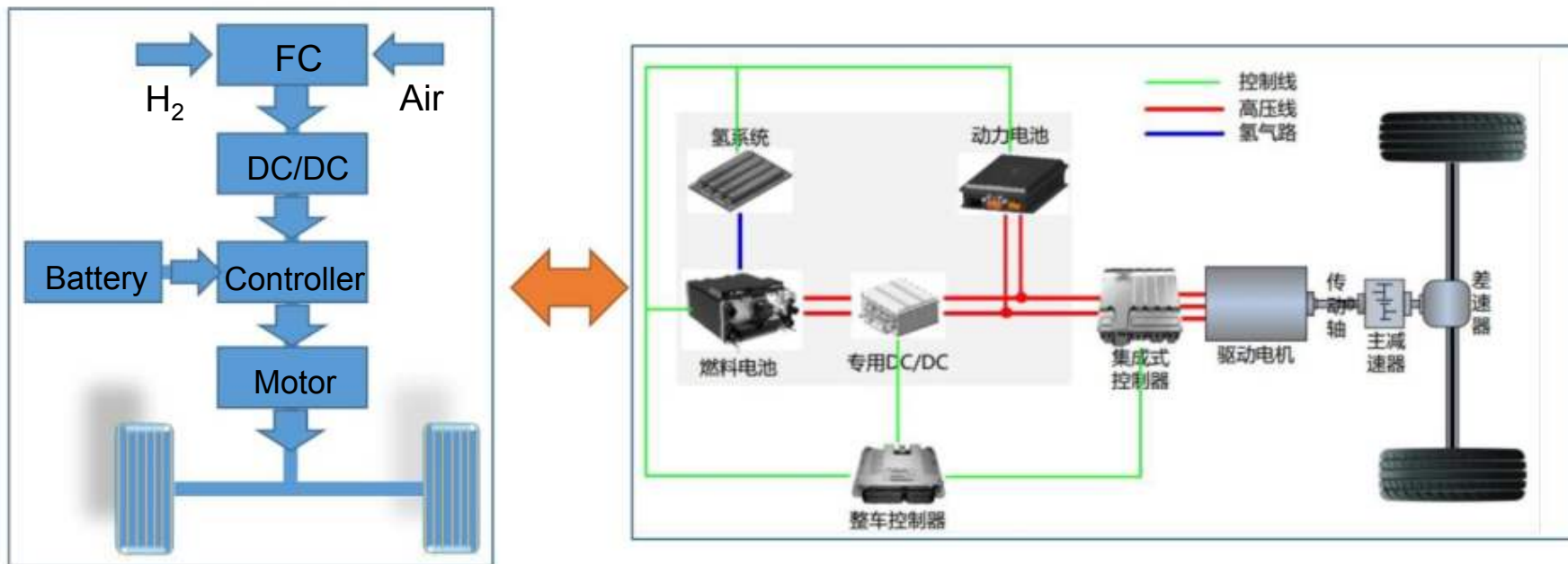
典型FCV 动力系统拓扑结构图
