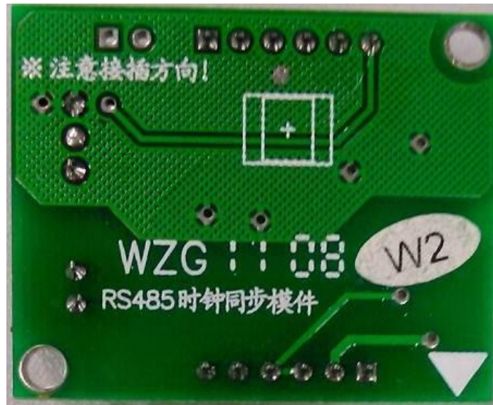
图 3-7 RS485 时钟同步模件
