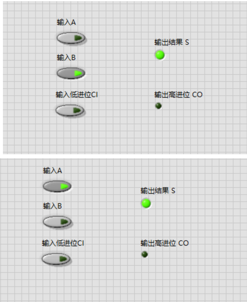
图 6.1 全加器调试过程
