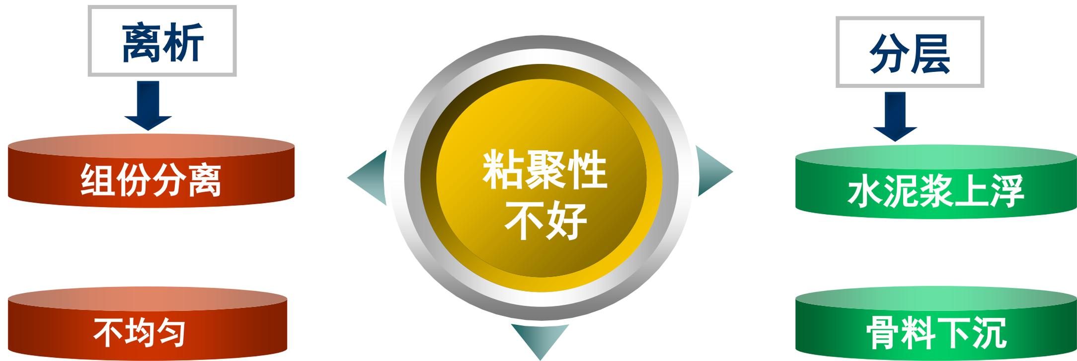
砼拌合物粘聚性不良时，硬化后会出现**蜂窝**、**麻面**。大型的砼拌和物，甚至出现狗洞现象。
