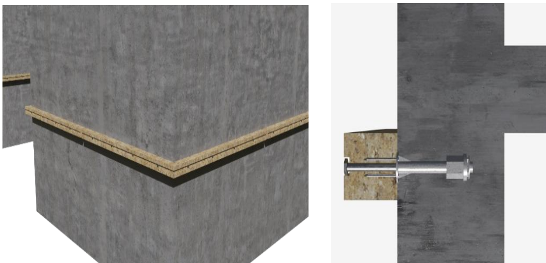
图 4.0-1 预制砼线条后置安装原理图
