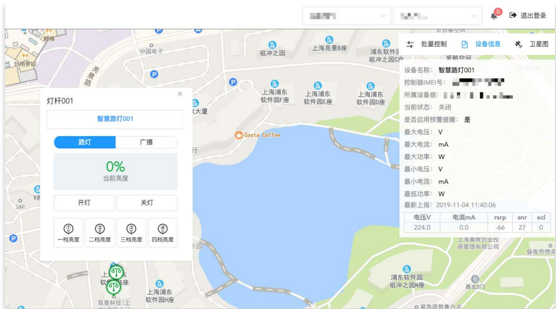
图1-1-5, 单设备操作, 显示设备信息
