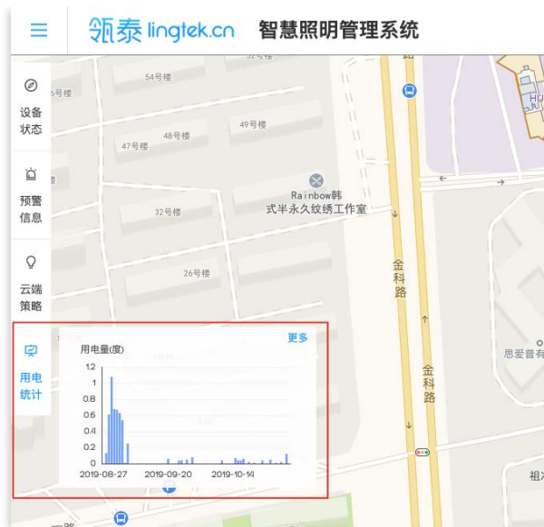
图1-1-2，点击用电统计，显示用电量柱状图
