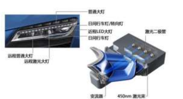
图 11：奥迪 A8 搭载的矩阵式激光大灯结构
