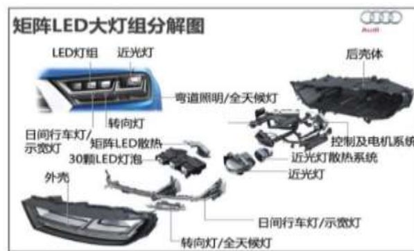
图 14: 奥迪矩阵式 LED 大灯组拆解
