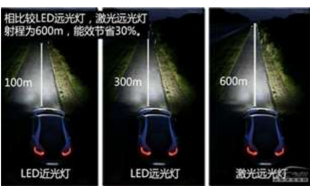
图 8：宝马激光大灯与 LED 大灯照明效果对比
