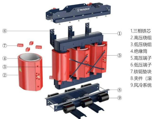
图：干式变压器结构图
