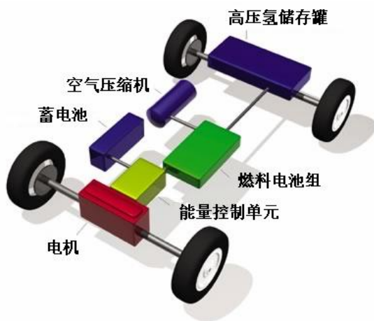
图 2.1.3 氢燃料电池汽车的结构布局
