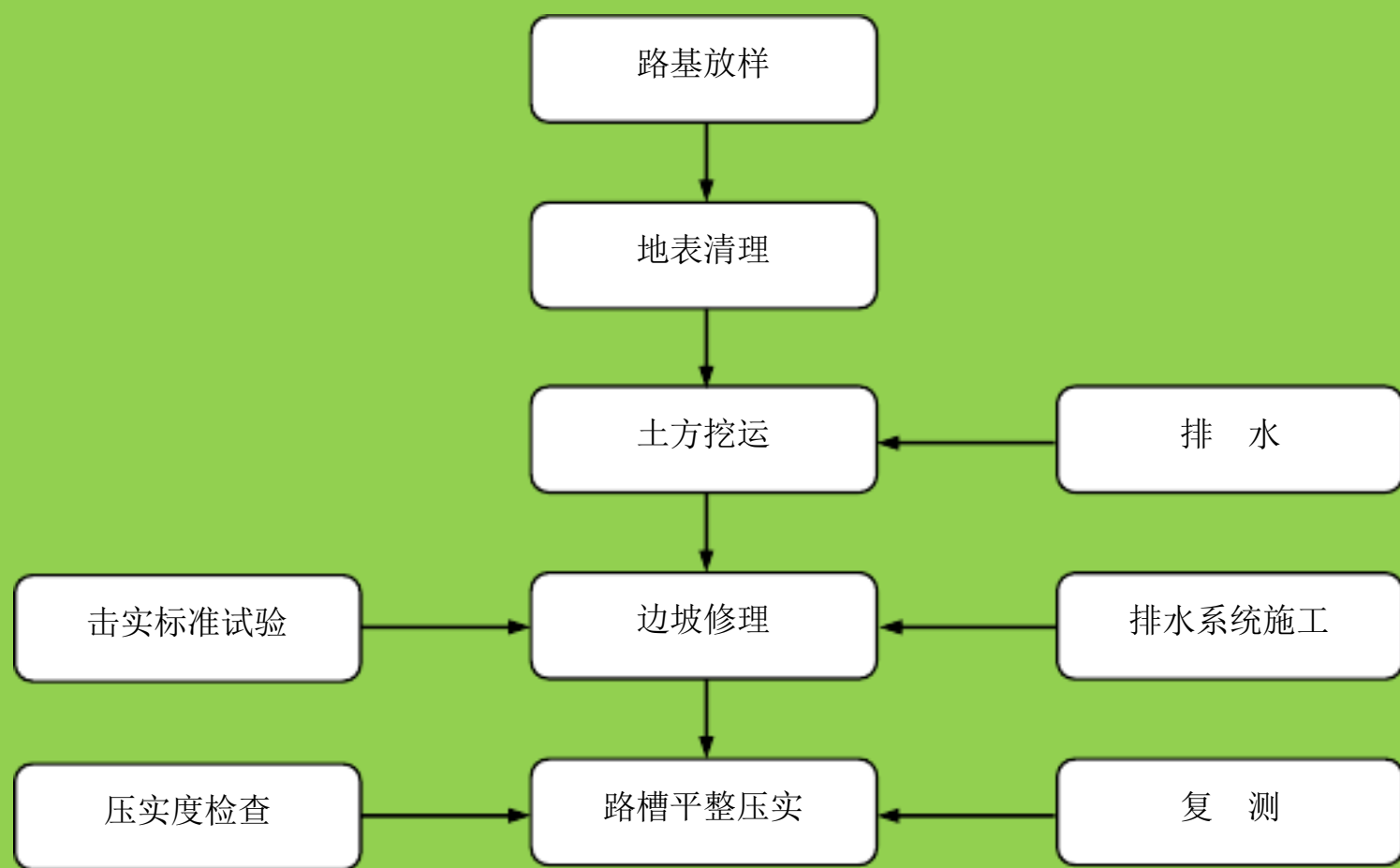
图 3-1 土方开挖工艺流程图
