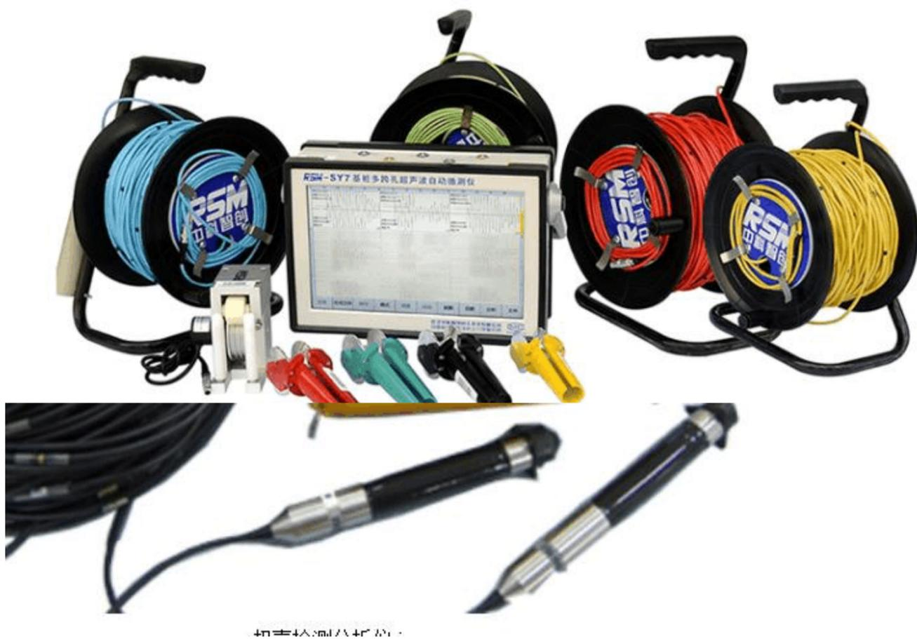
超声波测试仪、扶正器、传感器及信号发射器接收器(探头  $\phi$  32mm, 连接带有刻度的电缆), 三脚架、钢卷尺 1 把, 计数器等。
