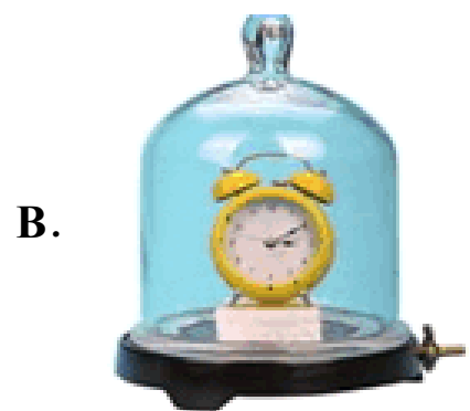
不能听到真空罩中闹钟的铃声，说明声波的传播需要介质
