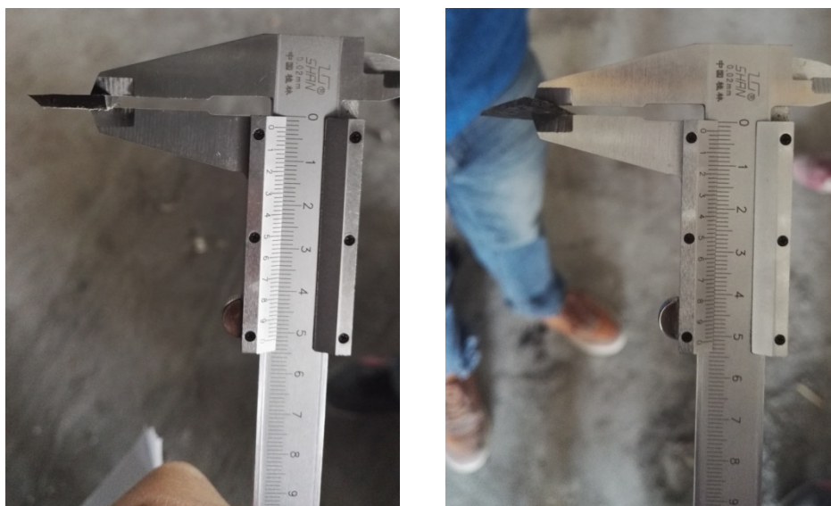
图 4.2.3 防水层厚度检查
