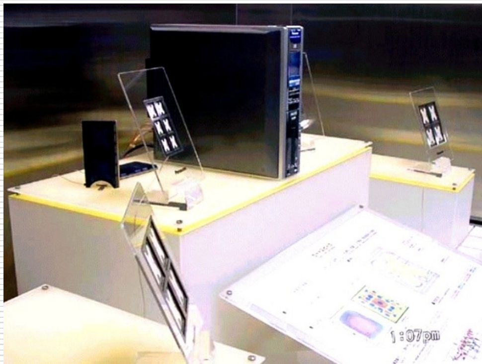
高分子压电薄膜制作的压电喇叭 (逆压电效应)
