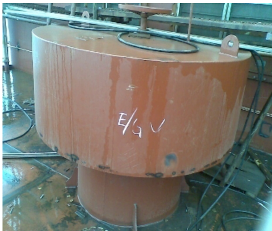
蘑菇型通风管高度小于760mm
