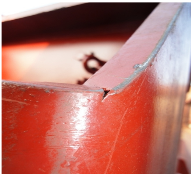
导览滚轮的拐角处有裂纹，标准中不允许补焊
