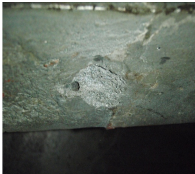
压载舱内的锌块没有标记，锌块很轻易就能剥落
