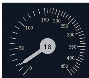
图 7 CTCS-3 级列控车载设备休眠模式时的速度表盘
