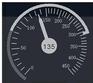
图5 CTCS-3级列控车载设备速度表盘
