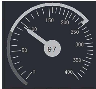
图6 CTCS-2级列控车载设备速度表盘
