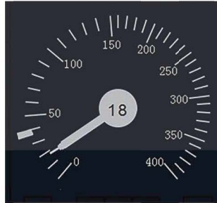
图 10 CTCS-2 级目视、调车、部分监控和引导模式时的速度表盘
