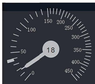
图 9 CTCS-3 级目视、调车、部分监控、机信和引导（C2 顶棚引导）模式时的速度表盘
