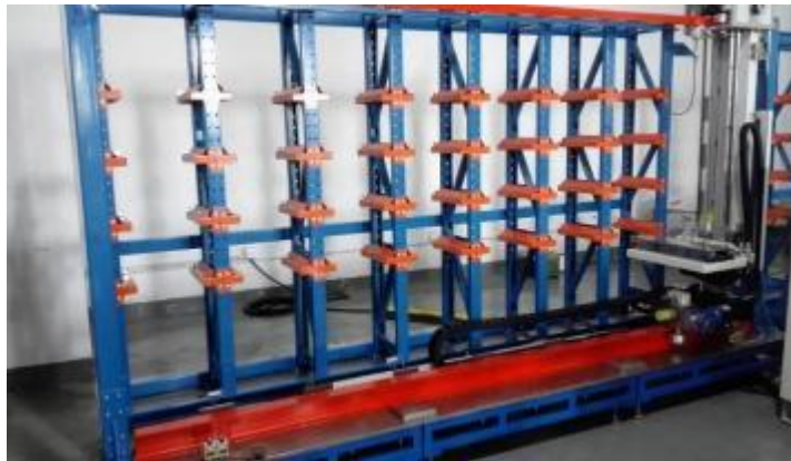
图7 码垛机立体仓库单元
