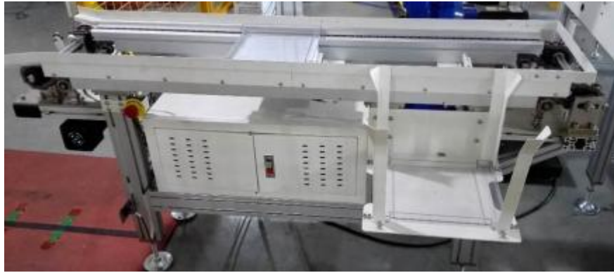
图8 分拣作业流水线
