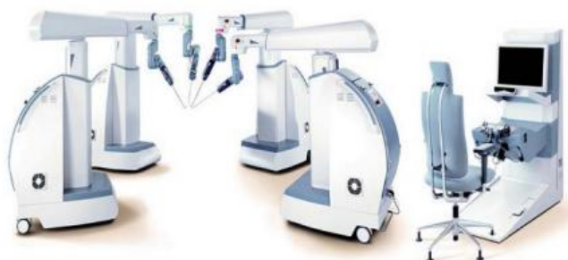
图 1.5 Senhance 手术机器人系统
