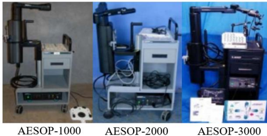
图 1.1 AESOP 系列机器人辅助微创手术系统
