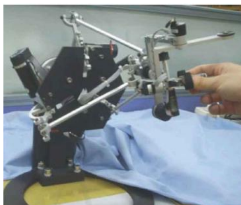
图 1.12 哈尔滨工业大学串并联混合型主操作手
