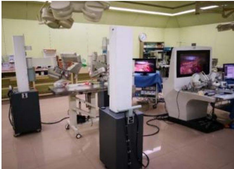
图 1.7 “华鹊 II”微创手术机器人系统
