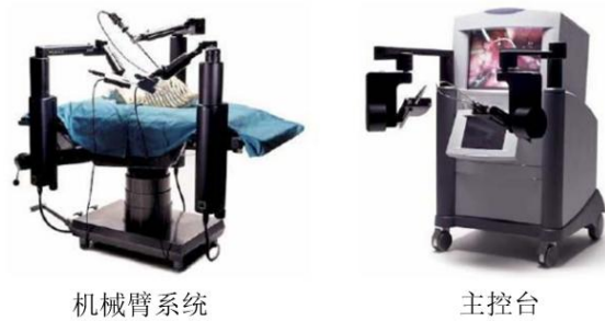
图 1.3 ZEUS 微创手术机器人系统
