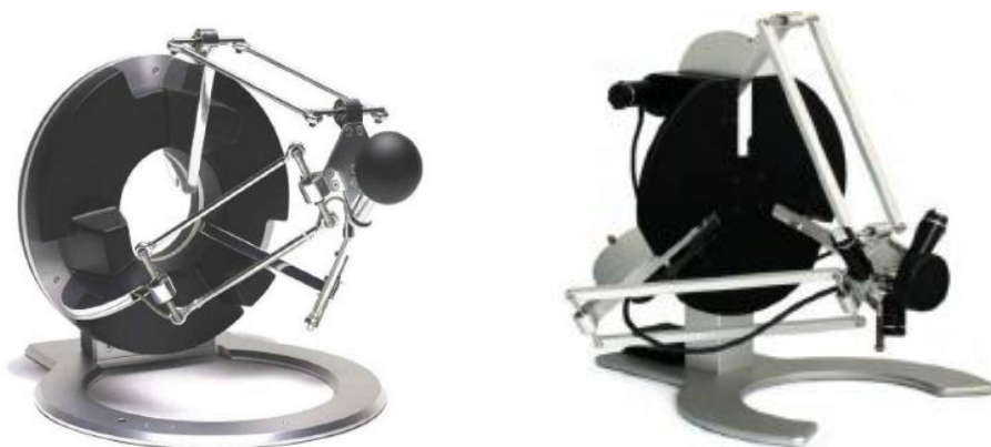
a. 3.DOF omega 3 力觉主操作手
