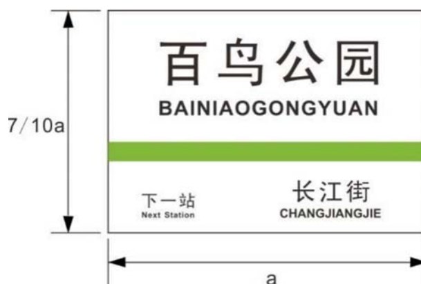
图 2 悬挂式导向标志外形尺寸示例
