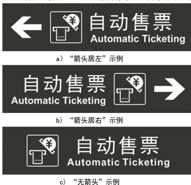
图 1 导向标志版面中英文对齐方式设计示例
