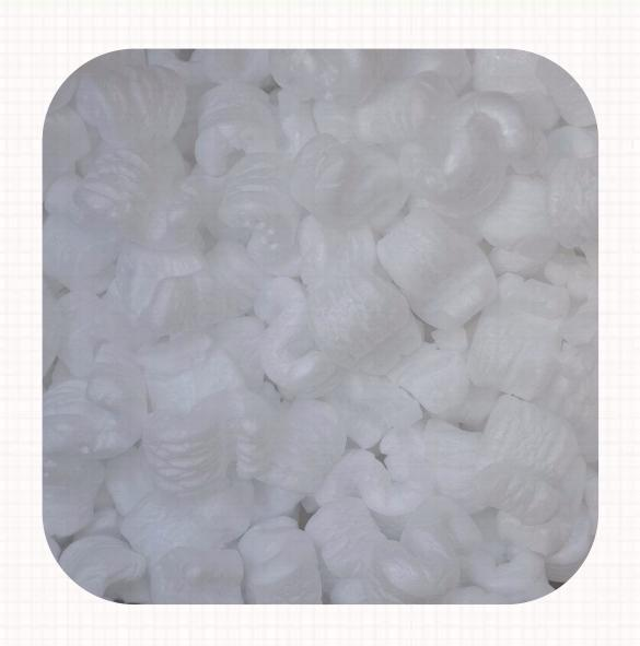
根据生产工艺, PS可分为通用级聚苯乙烯(GPPS)和发泡 聚苯乙烯(EPS)。
