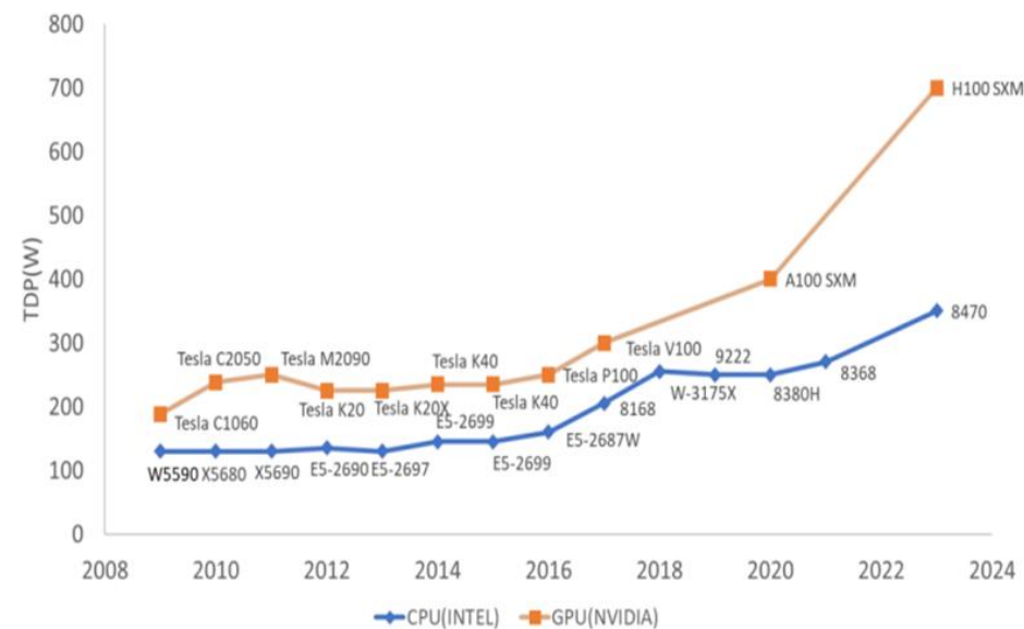
图 2：CPU/GPU TDP变化趋势
