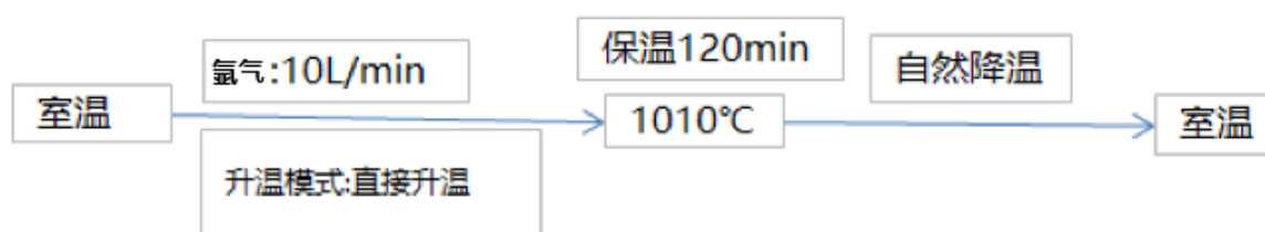
图5 反应炉温度均匀性测试工艺过程
