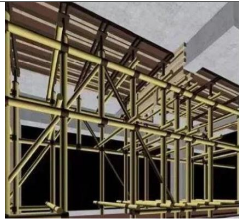
图4.2 穿后浇带洞口位置加固措施
