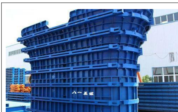
图2.11 墩柱定型钢模板
