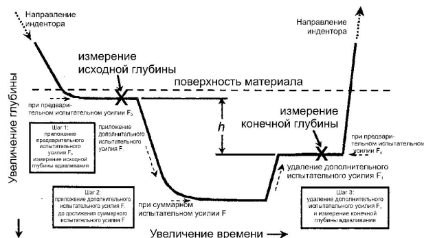
Рис. 1 Метод испытания на твердость по Роквеллу (принципиальная схема)
