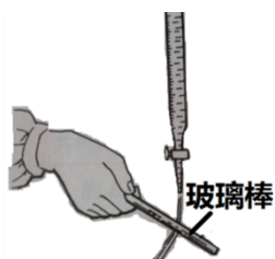
带电玻璃棒靠近液流实验
