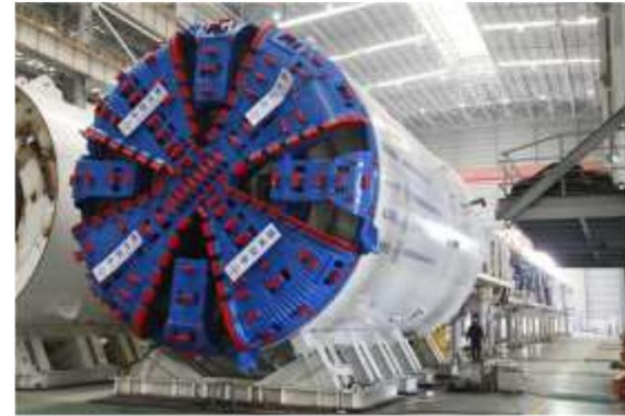
福建地铁2号线泥水平衡盾构机
