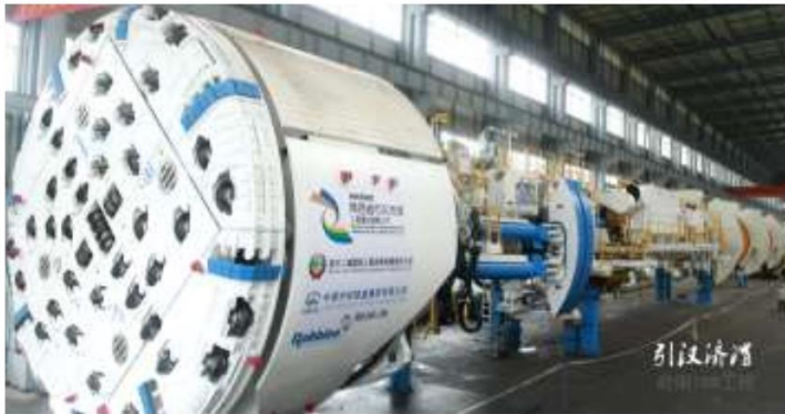
引汉济渭工程岭南标段撑靴式TBM
