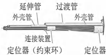
图10 鞍座过渡管、延伸管示意图
