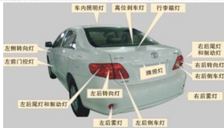
丰田卡罗拉轿车各种照明与信号灯位置
