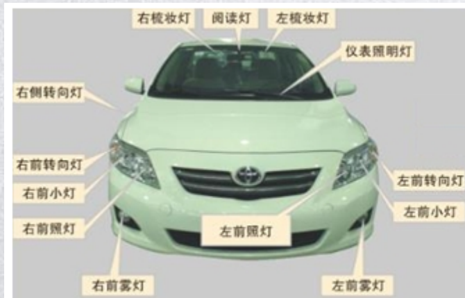
丰田卡罗拉轿车各种照明与信号灯位置
