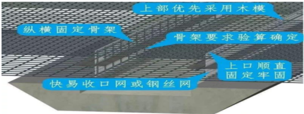
后浇带快易收口网做法示意图二
