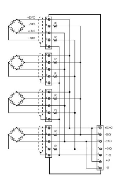
从本仪器侧面看到的n 个并联载荷 传感器群的额定容量是n 倍, 其灵 敏度可以认为与单个传感器的灵敏 度一样。平均化电阻(R)为 300~500 Ω,必须使用相对比一样,温度系 数较好的产品。使用已经并联连接 的载荷传感器时,不需要平均化电 阻。
