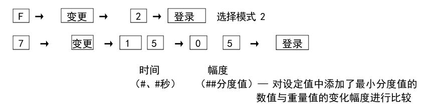
如果重量值的变化幅度低于设定的幅度,且该状态持续的时间超过设定的时间后,可认为重量值已经稳定,稳定信号为0N。动态检测包括稳定模式和校验模式两种。
