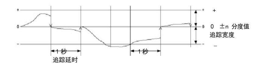
\* 由于毛重从零点开始动作,重量已经超过幅度时自动调零不起作用。请重新通过数字置零或零校准等方式获取零点。
