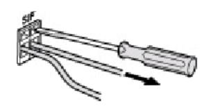
\* 可连接的电线为 0.2~2.5mm<sup>2</sup>。 请不要在电线的前端装上压紧端子或焊接焊锡等。 连接多股电线时,请事先把电线拧成一块后连接。
