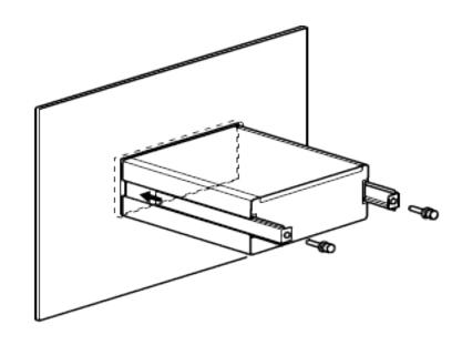
(4) 用仪器附带的 4mm 的螺钉紧紧地固定两边的安装接头。
