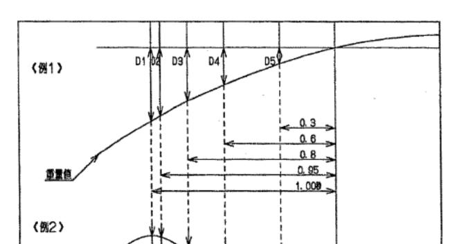
在校验模式中,每次 A/D 转换时要把下图中的 $D1^{\sim}D3$  与设定的幅度进行比较,只要其中任何一项超过幅度的话,稳定信号立刻变成OFF。
