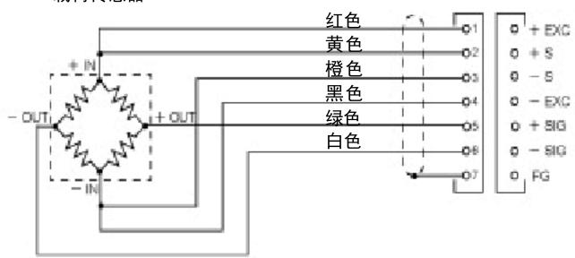
所谓的遥感式是指:由于随着温度的变化电缆的电阻也产生变化,为防止施加给载荷传感器的外加电压出现变动,使接近载荷传感器位置的外加电压稳定的方式。
