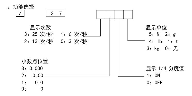
F701 作为符合称量法型号认可的称量秤使用时,请把1/4 分度值显示设定为 0FF。设定为0FF 后, "零点"在真正的零点(0±1/4 分度值)处亮灯。
