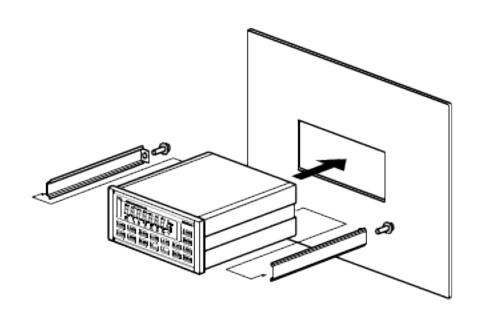
(3) 从指示计的背面把安装导轨插入指示计的两边。
