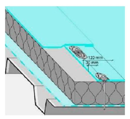
5. PVC 防水卷材固定: 紧固件和垫片沿标记线所示的距卷材边缘 30MM 处固定卷材。
