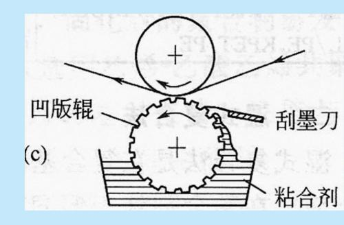
黏合剂采用凹版辊涂布法时,涂布量要根据复合基材的特点来选择,通常未经印刷或印刷面积较小的基材,涂布量在1.5~2.5g/m²;纸张等基材或印刷面积较大的基材,涂布量在2.5~3.5g/m²;包装干燥类食品的基材,涂布量在2~2.5g/m²;包装含水食品的基材,涂布量在2.5~3g/m²;耐蒸煮的基材,涂布量在2.5~4g/m²;铝箔蒸煮的基材,涂布量在4g/m²以上
