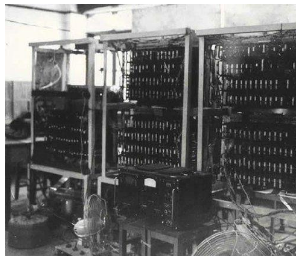
新中国第一台电子计算机由1280只电子管构成
