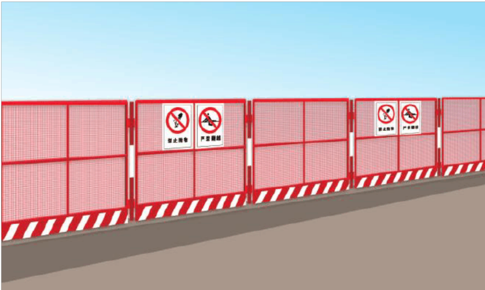
图 4.2-24 小箱梁吊装临边防护示意图
