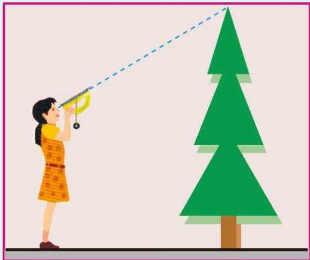
将仪器用手托起，拿到眼前，使视线沿着仪器的直径刚好到达树的最高点（如图）。
